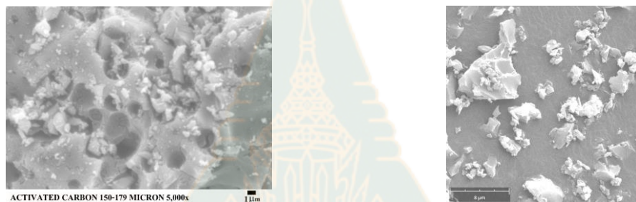
ภาพที่ 4.17 สัณฐานวิทยาของผงถ่านกัมมันต์ด้วยกล้องจุลทรรศน์อิเล็กตรอนแบบส่องกราด
