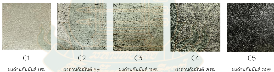
ภาพที่ 4.19 กระดาษจากเส้นใยฟางข้าวผสมเส้นใยกระดาษใช้แล้วเคลือบผงถ่านกัมมันต์ที่ปริมาณต่าง ๆ
